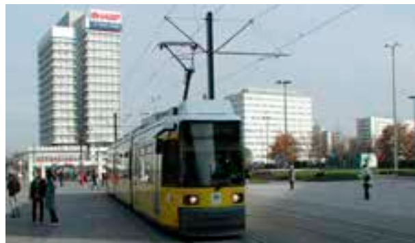
Køreledninger ophængt i centerstillede master med bæretov.
