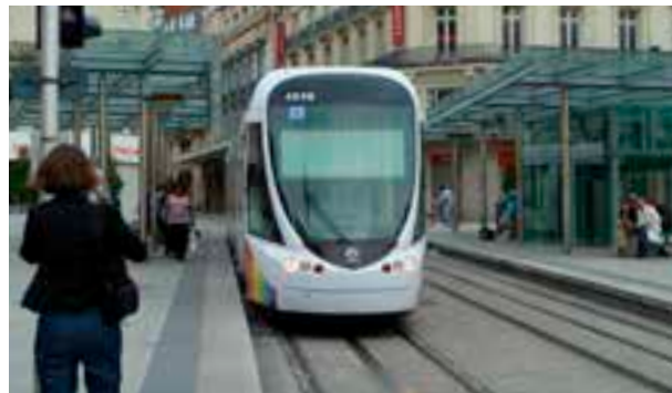
Løsning med strømforsyning fra skinne i tracé.
